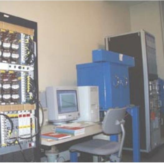
Abb. 5: Messraum mit der Low-level-Alpha-Spektrometrie (links im Vordergrund) sowie zwei Low-level-Gamma-Spektrometern mit Bleiabschirmungen (in blau).
